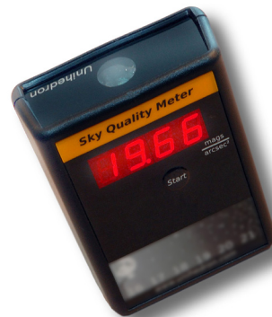
Bild 15. Sky quality meter (SQM) är ett instrument som används för att mäta ljusföroreningar från marken. Bild: Lamiot / CC BY-SA ( https://creativecommons.org/licenses/by-sa/3.0 )
